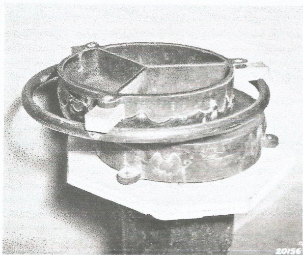
Fig. 1. Achterzijde van de 30 cm-spiegel. Duidelijk ziet men de aangegoten uitsteeksels, waarmee later de spiegel in de telescoop wordt bevestigd. Tijdens het bewerken, wat met de hand geschiedt, is hieraan een houten ring als handgreep bevestigd.
